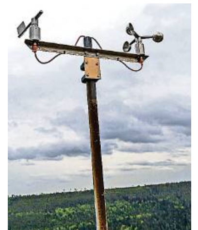
Mit dem Windrichtungsgeber und dem Propeller können Richtung, Geschwindigkeit und Stärke des Winds gemessen werden.
